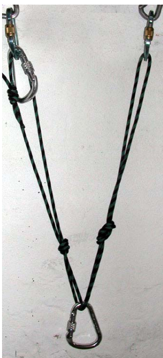
Fig. 3: La sosta semimobile.
