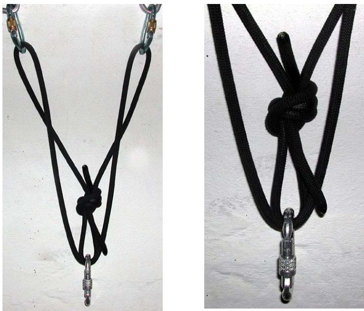
Fig. 4: La sosta ad asola inglobata e un particolare del nodo al vertice.
